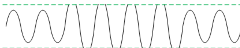
图 8-2. NCN_OFF 模式下的音频输出信号
